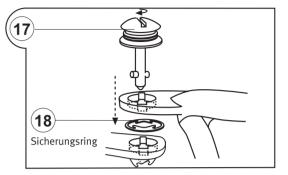
Zur Demontage des QUICK-LOCK-Kofferträgers einfach mit einer Münze oder einem Schraubendreher die Schnellverbinder lösen und Seitenträger entfernen.
