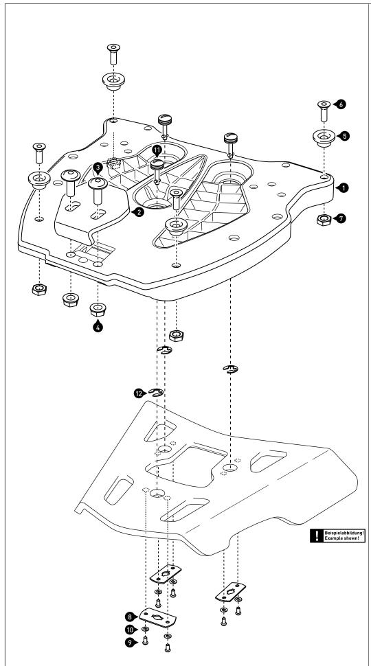
Montieren Sie die gezeigten Komponenten an der Adapterplatte (1) und ALU-RACK (nicht im Lieferumfang enthalten). Ziehen Sie die Schrauben wie in der Stückliste vorgegeben an.
