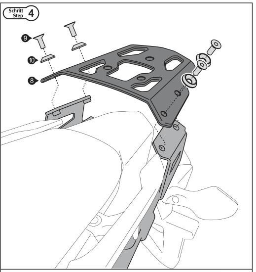
Verschrauben Sie das ALU-RACK (8) auf den Rohrstreben (2) wie gezeigt. Sichern Sie die Schrauben (9) mit flüssiger Schraubensicherung. Ziehen Sie nun die Schrauben (9) an.
