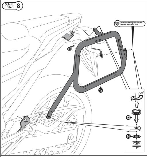
Befestigen Sie beidseitig die Kofferträger (12) mit den Schnellverschlüssen (13) an den Befestigungsblechen (2) und (6) bzw. Querverbinder (15). Sichern Sie die Schnellverschlüsse (13) mit den Sicherungsscheiben (14). Wenn alle Komponenten spannungsfrei und symetrisch sitzen, ziehen Sie die Schrauben (3), (7), (10) und (16) (in dieser Reihenfolge) nach den Vorgaben an:
