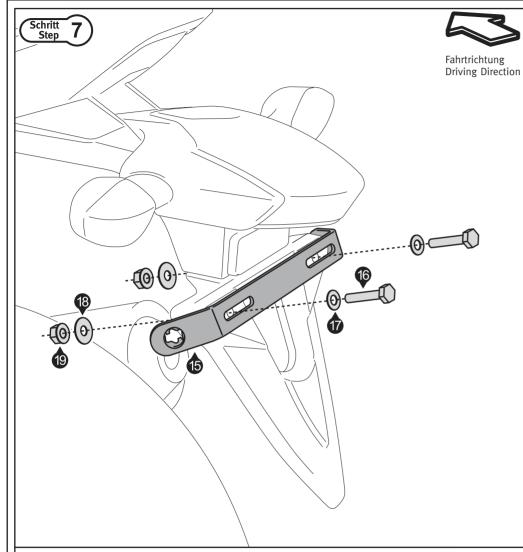
Verschrauben Sie den Querverbinder (15) am Kennzeichenhalter wie gezeigt. Ziehen Sie die Schrauben (16) noch nicht an.
