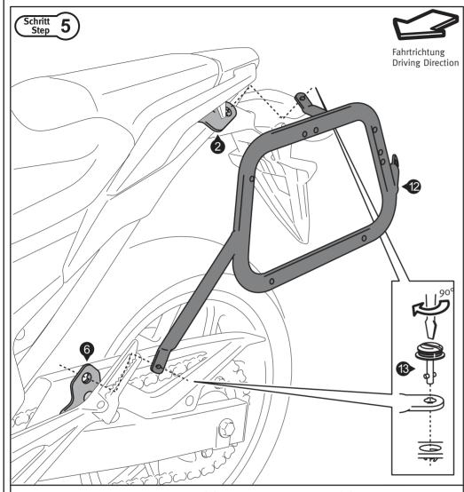
Befestigen Sie die beidseitig die Kofferträger (12) mit den Schnellverschlüssen (13) an den Anbaublechen (2) und (6).
