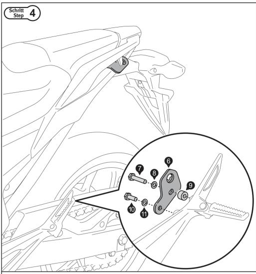
Montieren Sie die Befestigungsbleche (6) beidseitig hinter den Sozius-Fußrasten, wie gezeigt. Sichern Sie die Schrauben (7) und (10) mit flüssiger Schraubensicherung. Ziehen Sie die Schrauben (7) und (10) noch nicht an.
