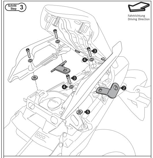
Verschrauben Sie die Befestigungsbleche (2) mit den Sozius-Haltegriffen am Fahrzeug. **Sichern Sie die Schrauben (3) mit flüssiger Schraubensicherung.** Ziehen Sie die Schrauben (3) noch nicht an.
