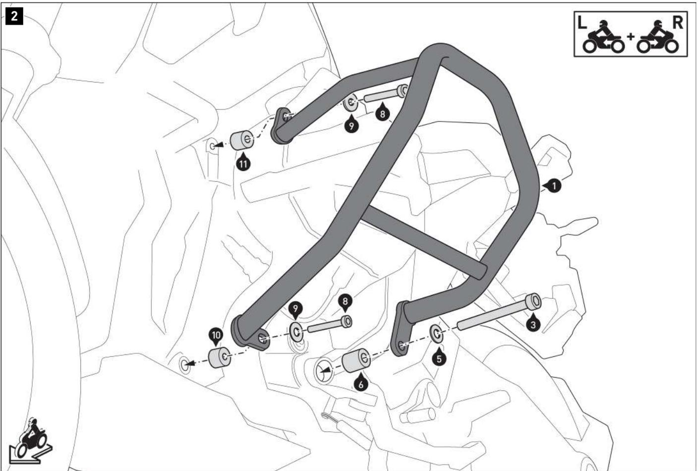
Verschrauben Sie den linken Sturzbügel (1) am Fahrzeug.
