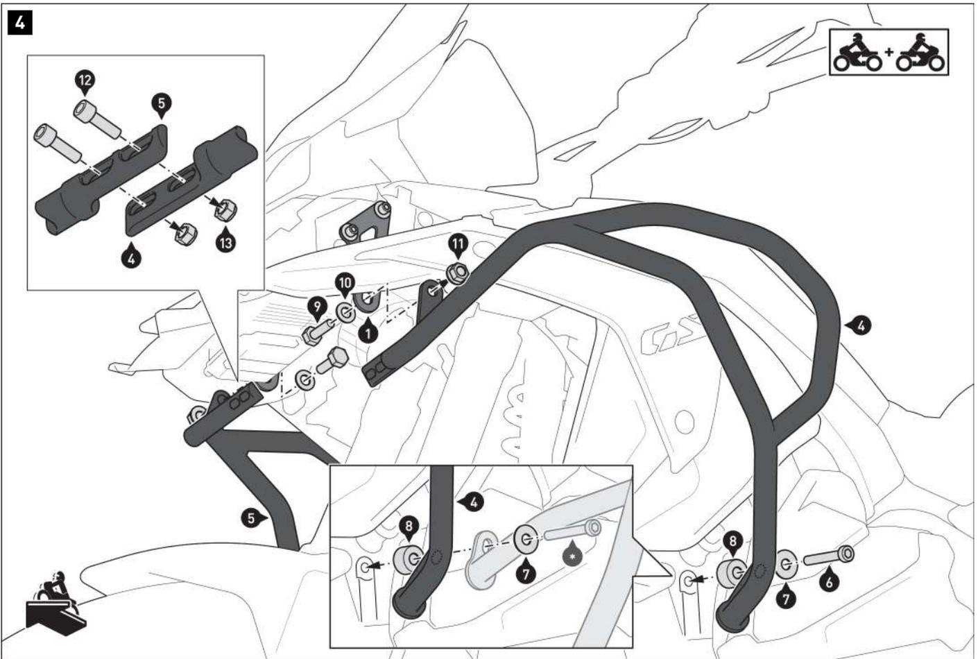
**⚠ HINWEIS:** Falls dieses Produkt mit dem SW-MOTECH Sturzbügel verbaut werden soll, ändert sich die Verbausituation am unteren Anbaupunkt (siehe untere Detailzeichnung). Verwenden Sie die dem Sturzbügel beiliegenden Schrauben (\*).
