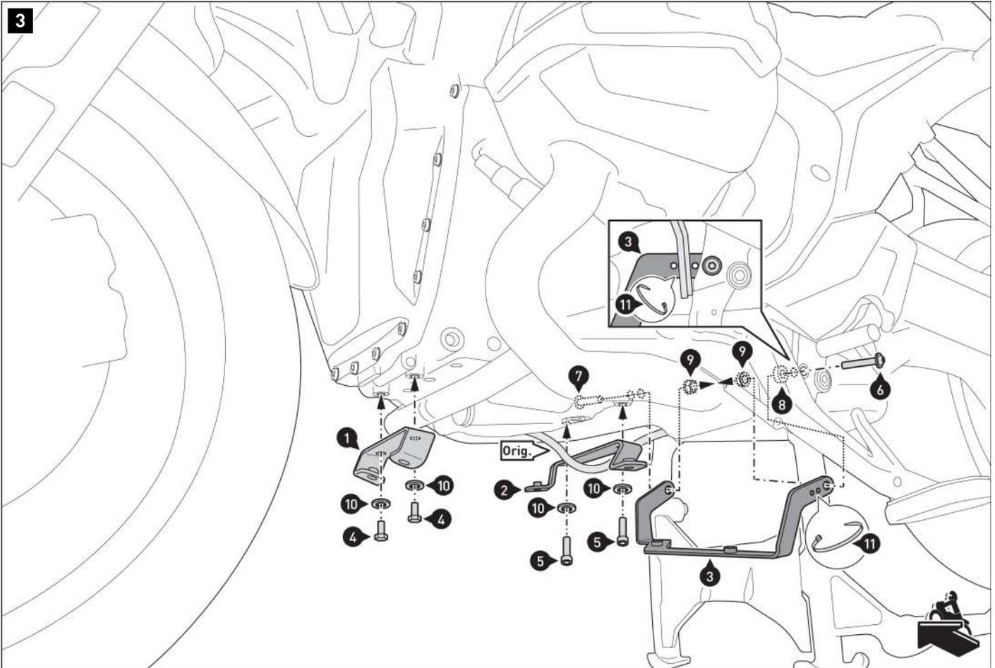
Verschrauben Sie das vordere Anbaublech (1), das mittlere Anbaublech (2) und das hintere Anbaublech (3) am Fahrzeug.
