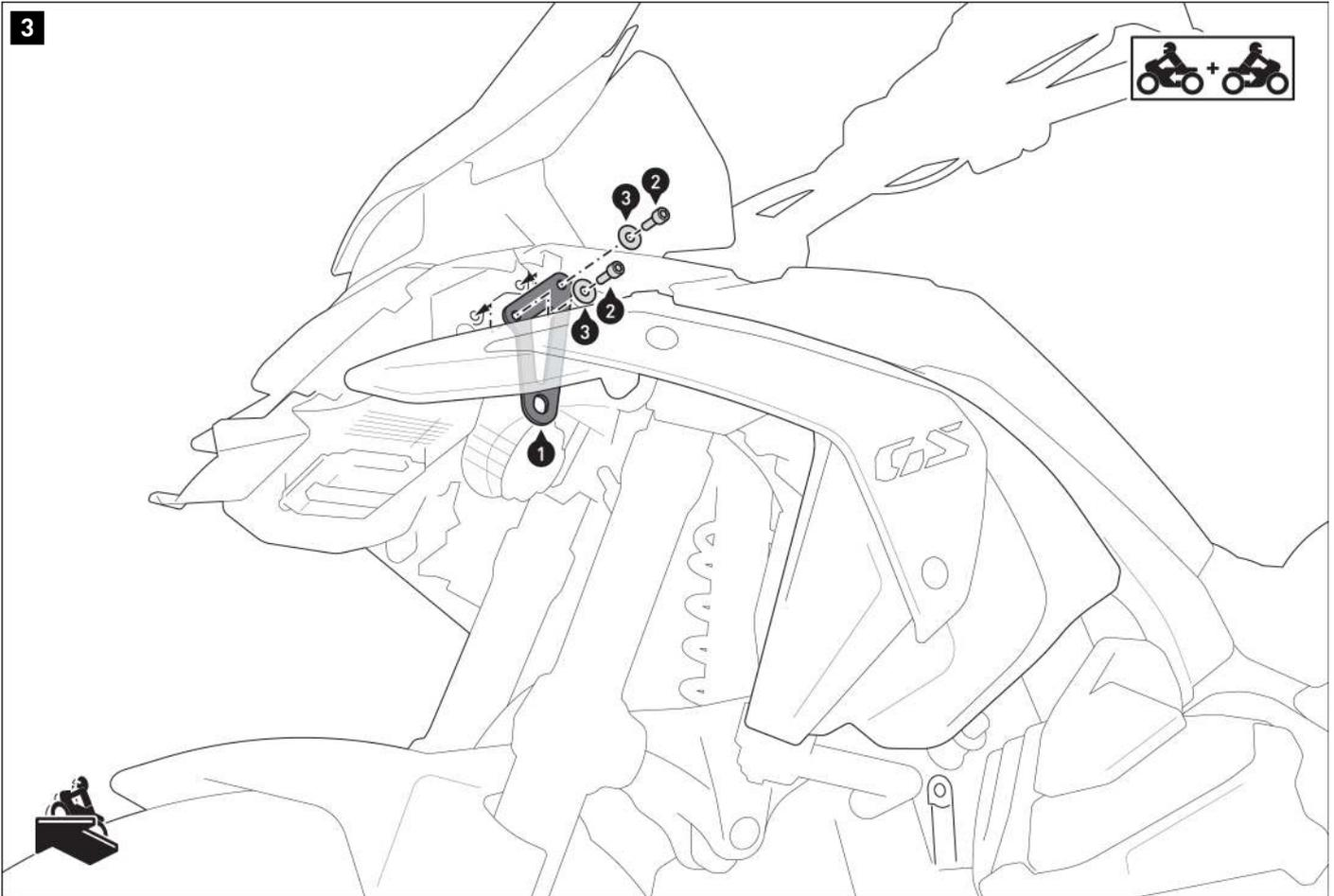
Verschrauben Sie die Anbaubleche (1) beidseitig am Fahrzeug. Achten Sie darauf, die an den Anbaupunkten befindlichen Kabel innenseitig an den Anbaublechen vorbeizuführen.
