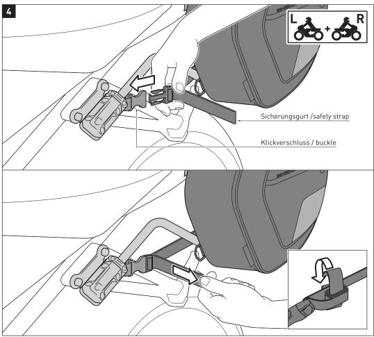
Rasten Sie nun die Sicherungsgurte der Satteltaschen (3) in die zuvor lose verschraubten Klickverschlüssen (1) ein. Ziehen Sie jetzt die Schrauben der Klickverschlüsse (1) an.
