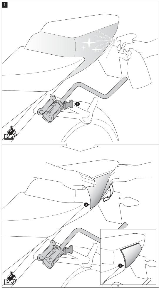
**DE -** Nachdem Sie die Abstandsbügel an Ihrem Fahrzeug montiert haben, müssen Sie die Auflageflächen der Satteltaschen mit der beigepackten Lackschutzfolie (2) bekleben, um Beschädigungen zu vermeiden. Reinigen Sie die zu beklebende Fläche vor dem Aufbringen der Lackschutzfolie gründlich von Fett- und Schmutz-
