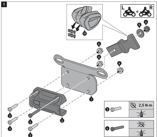
Montieren Sie die gezeigten Teile an den Anbaublechen (1) (rechtes Anbaublech gezeigt).
