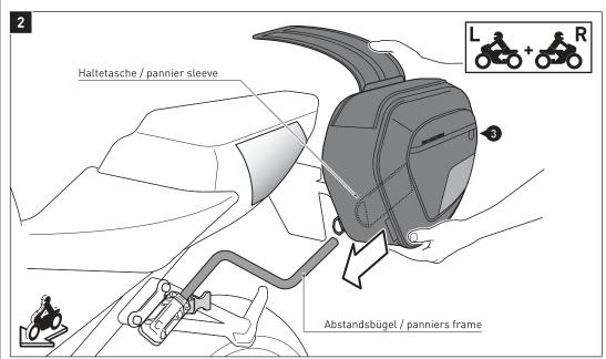
Schieben Sie anschließend die Haltetaschen der Satteltaschen (3) seitenweise über die zuvor montierten Abstandsbügel.
