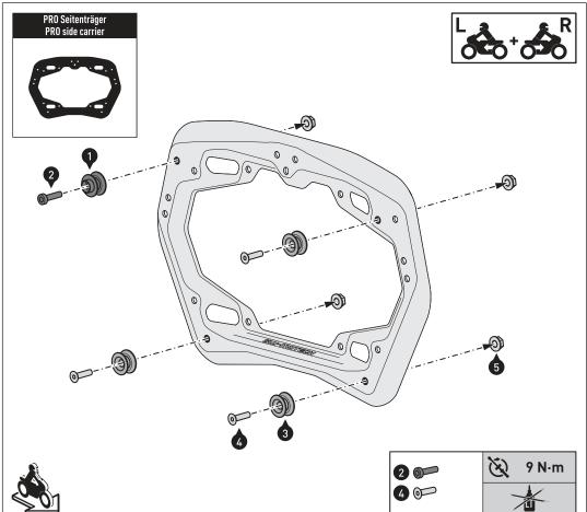
HINWEIS: Die Zeichnung zeigt die Montage am **rechten** PRO-Seitenträger. Montieren Sie die Teile am linken PRO-Seitenträger auf die gleiche Weise wie am rechten PRO-Seitenträger.
