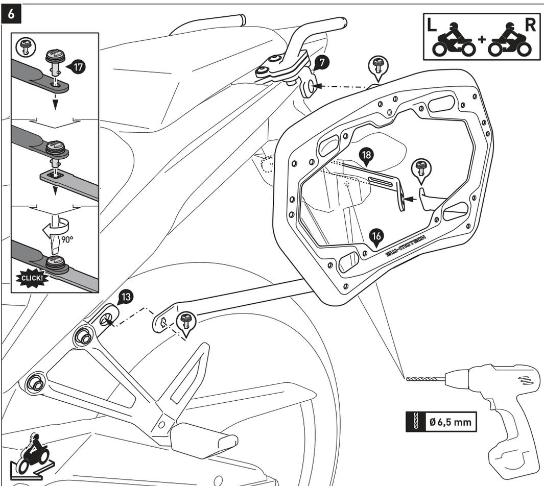
Verbinden Sie die Kofferträger (16) mit den Befestigungslaschen (7) und (13); verwenden Sie die Schnellverschlüsse (17) wie in der Detailzeichnung gezeigt. Verbinden Sie nun die hinteren Befestigungsausleger mit dem Querverbinder (18). Benutzen Sie auch hier die Schnellverschlüsse (17).
