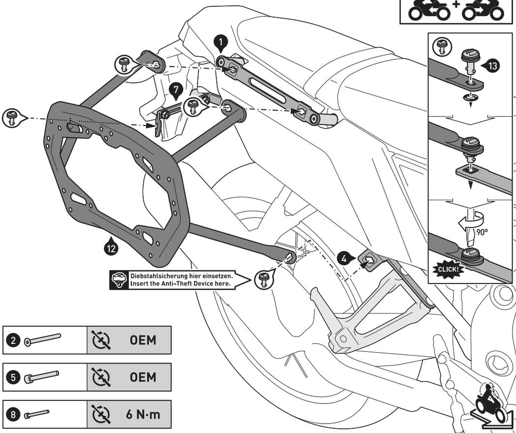
Verbinden Sie die Seitenträger (12) mit den Schnellverschlüssen (13) an den Befestigungslaschen (1) und (4) und dem Querverbinder (7), wie in der Zeichnung gezeigt. Sichern Sie die Schnellverschlüsse (13) mit den Sicherungsscheiben.
