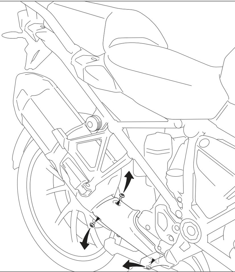
Lösen Sie die markierten Schrauben der Auspuffverkleidung und entfernen Sie diese vom Fahrzeug.
