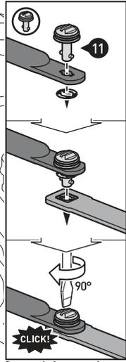
Verbinden Sie die Seitenträger (9) und (10) mit den Schnellverschlüssen (11) an den Befestigungslaschen und dem Querverbinder. Sichern Sie die Schnellverschlüsse mit den Sicherungsscheiben.
