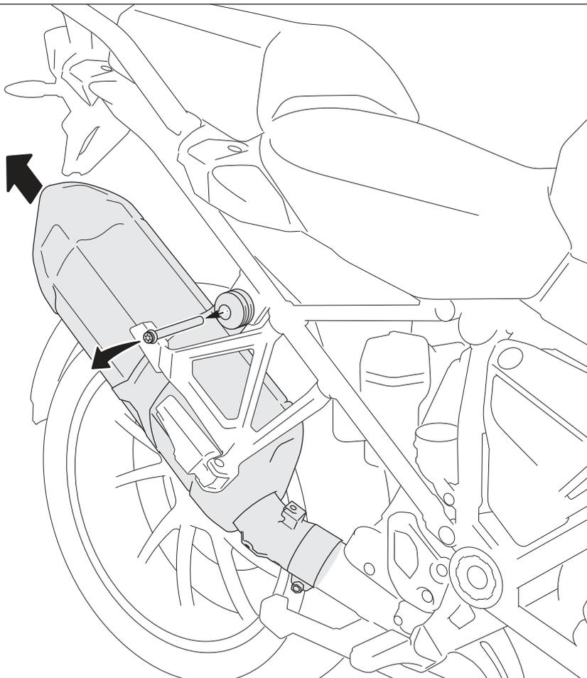
Lösen Sie die gezeigte Auspuff-Halteschraube und Auspuffschelle. Entfernen Sie den Endtopf vorsichtig vom Fahrzeug.
