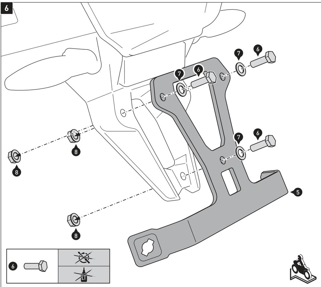
Verschrauben Sie den Querverbin-der (5) am Kennzeichenhalter, wie in der Zeichnung gezeigt. Ziehen Sie die Schrauben noch nicht an.
