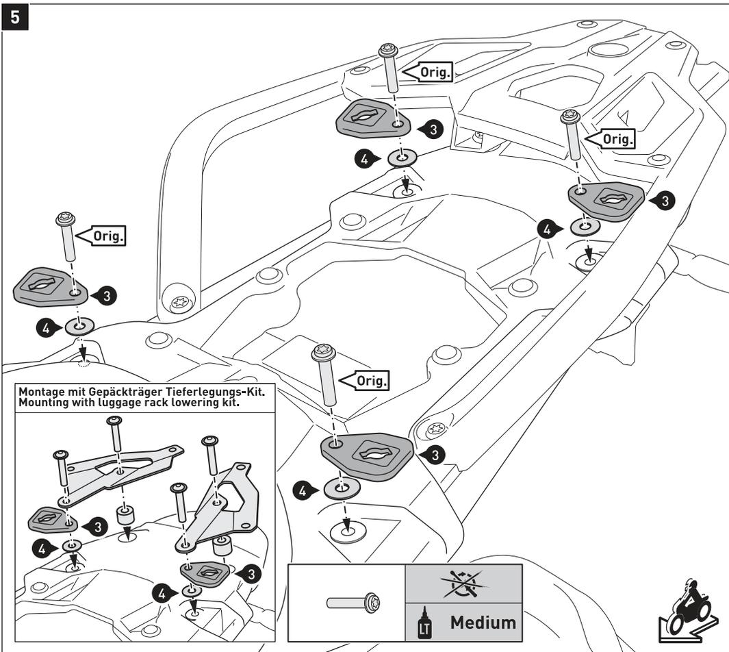
*HINWEIS:* Beachten Sie die in der Detailzeichnung gezeigte Verbausituation mit den SW-MOTECH Gepäckträger Tieferlegungs-Kit. Dabei entfallen die vorderen Distanzbuchsen des Tieferlegungs-Kit.
