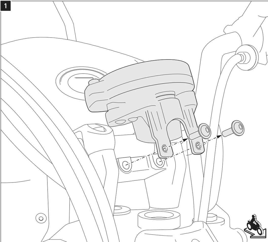
Lösen Sie die originalen Schrauben vom Tachometer, wie in der Zeichnung gezeigt.
