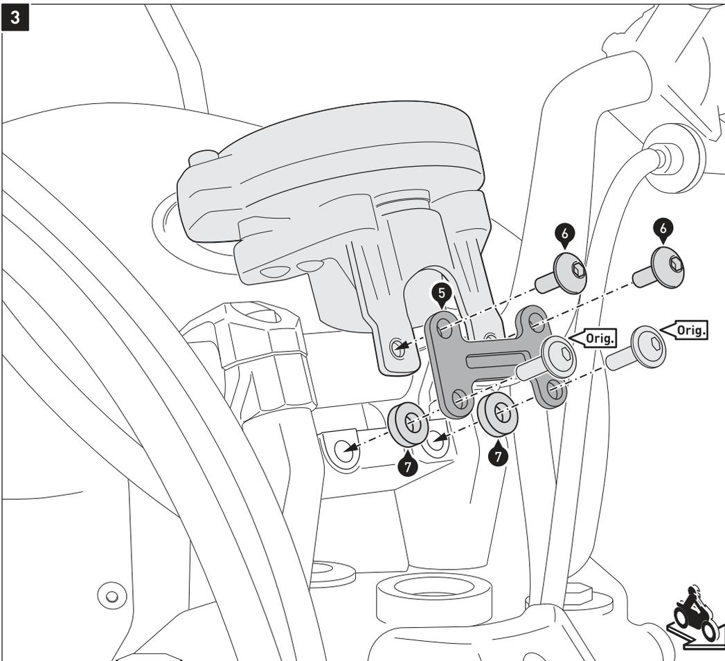
Verschrauben Sie das Anbaublech (4) mit den originalen Schrauben (Orig.) und den Schrauben (5) am Tachometer und Fahrzeug.
