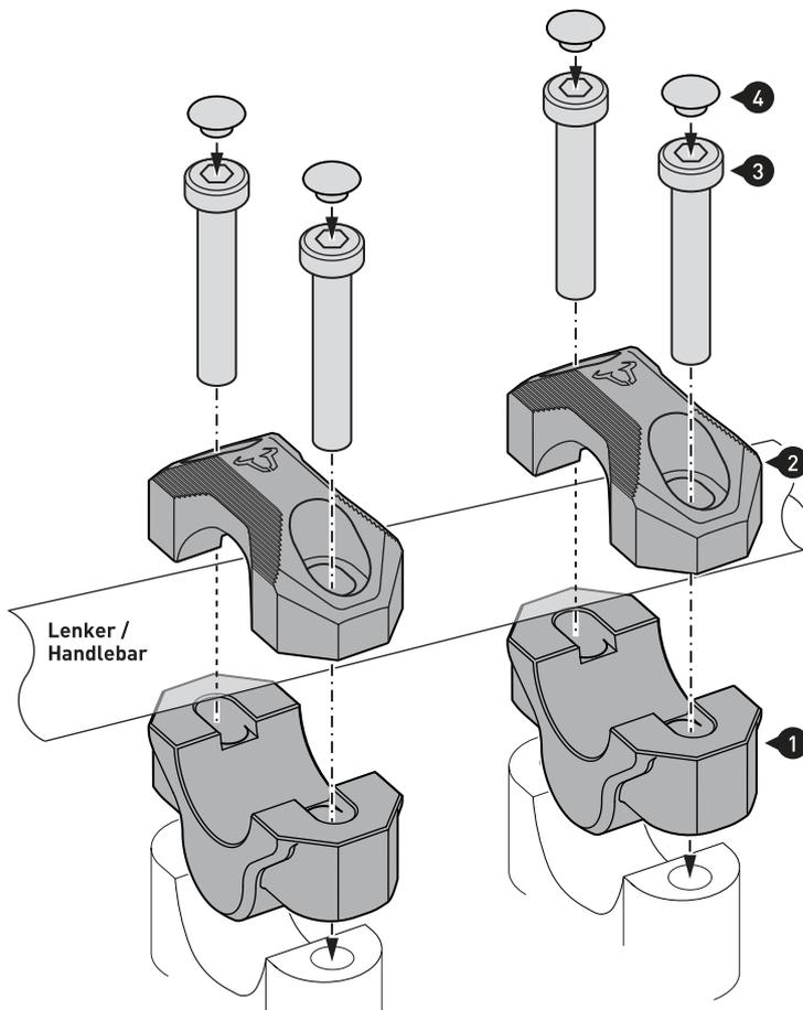
Verschrauben Sie die Lenkererhöhung (1) mit dem Lenker am Fahrzeug, wie in der Zeichnung gezeigt.
