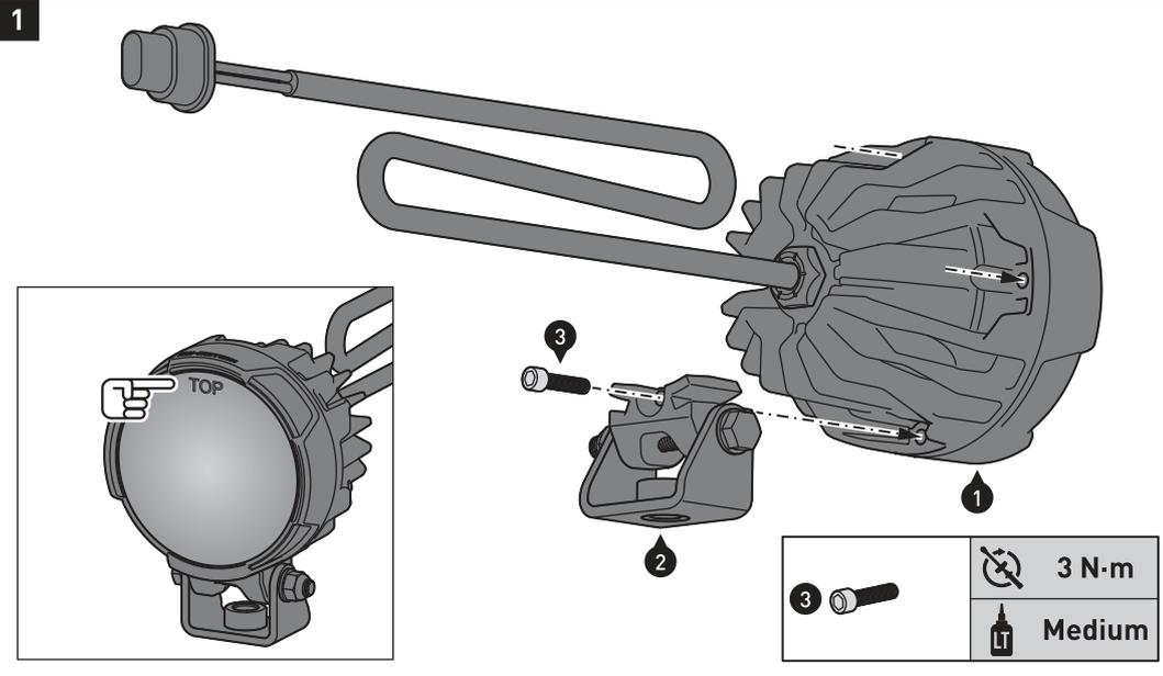
Die Scheinwerfer (1) können in hängender, stehender oder seitlicher Position verbaut werden. **ACHTUNG: Beachten Sie, dass die „TOP“-Markierung aufgrund der Reflektorkrümmung immer oben stehen muss.** Montieren Sie die Anbauadapter (2) an einem der Montagepunkte, wie in der Zeichnung gezeigt. **ACHTUNG: Verwenden Sie flüssige Schraubensicherung!** Ziehen Sie die Schrauben wie in der Stückliste vorgegeben an.
