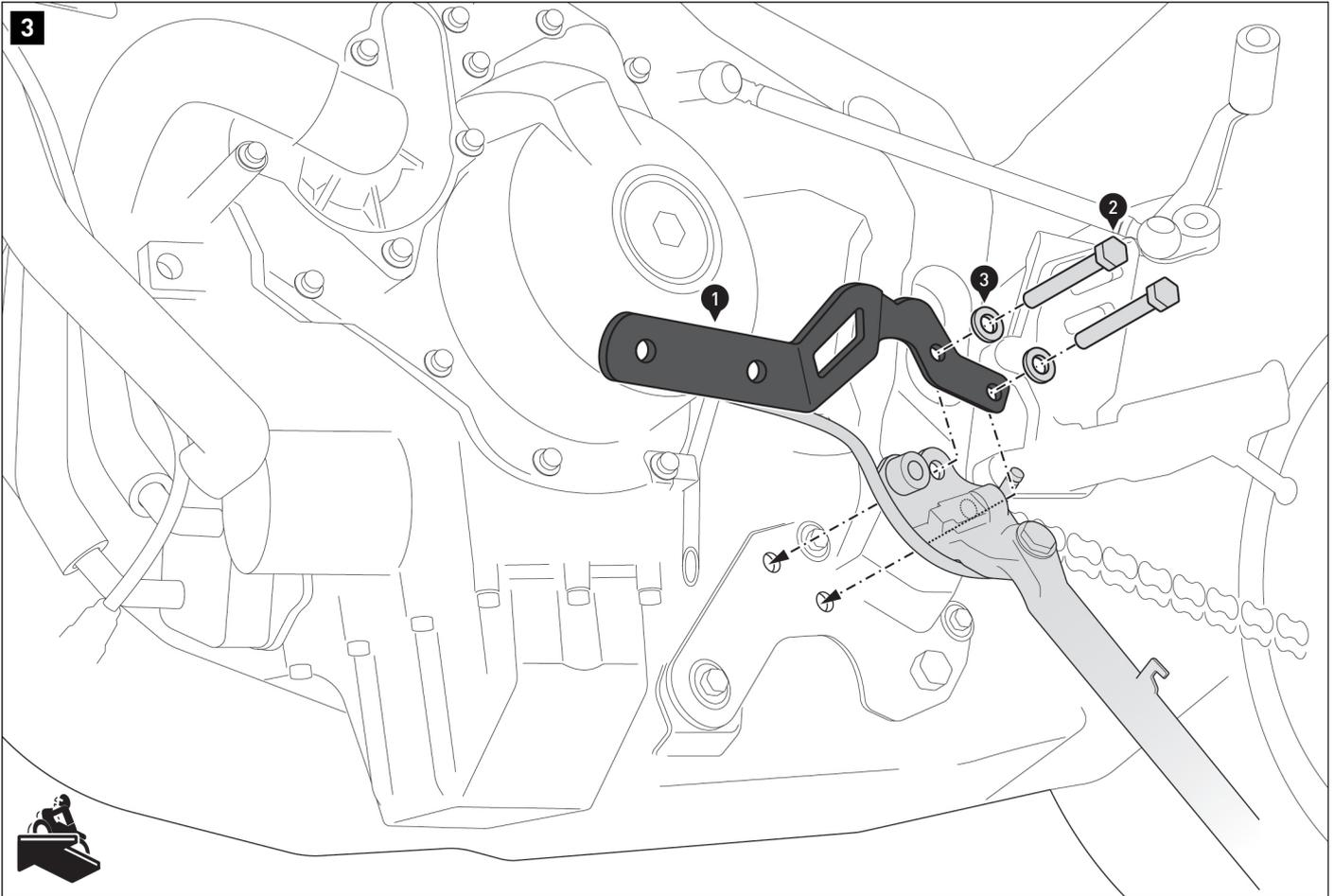
Verschrauben Sie das Anbaublech (1) mit dem Seitenständer auf der linken Seite am Fahrzeug.
