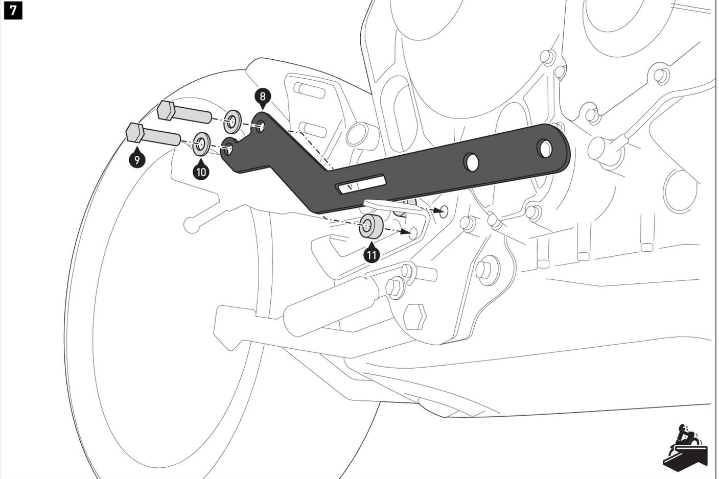
Verschrauben Sie das Anbaublech (8) auf der rechten Seite hinter dem Bremshebel am Fahrzeug.
