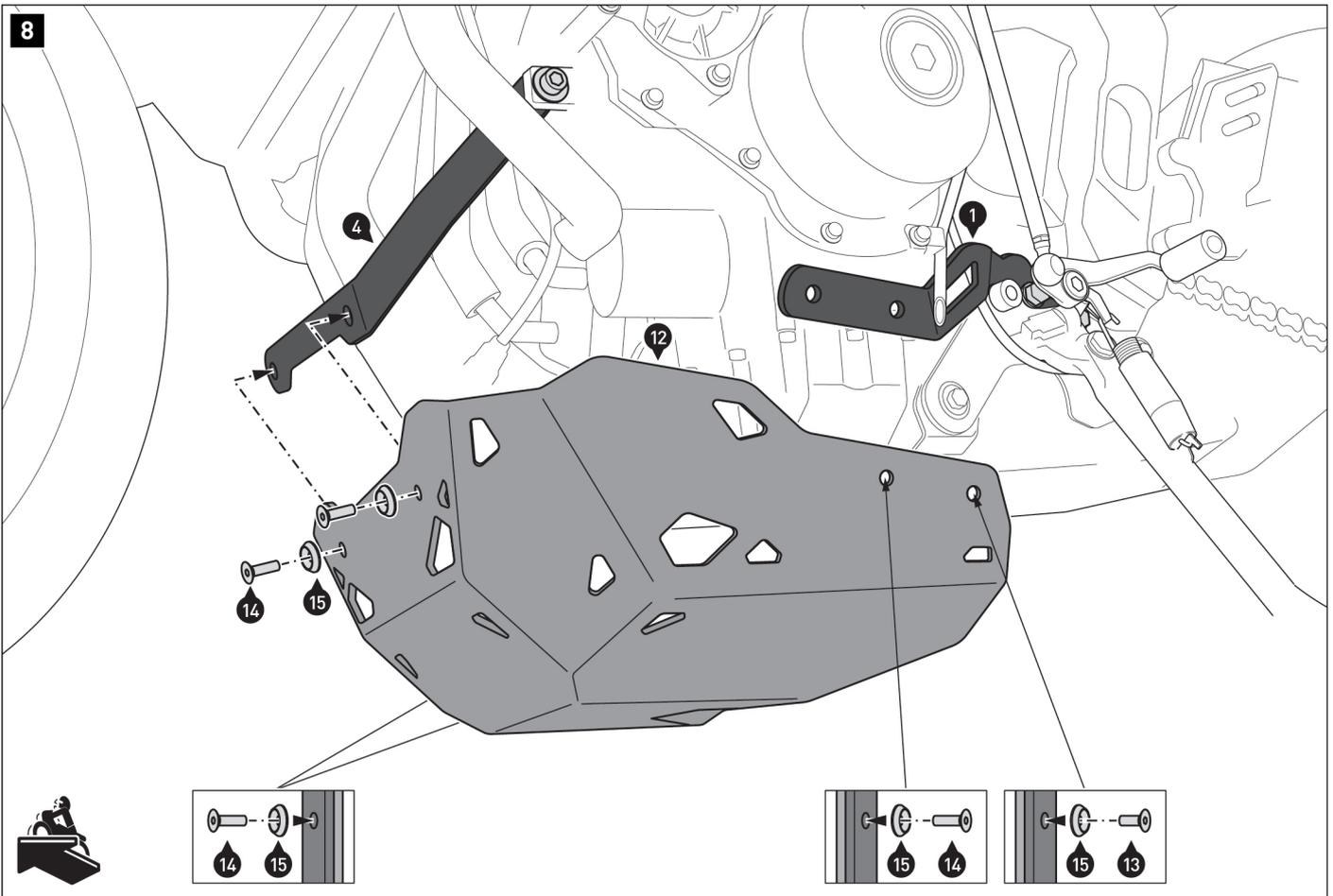
Verschrauben Sie den Motorschutz [12] an den Anbaublechen (1), (4) und (8). Beachten Sie die Position der Schraube (13).
