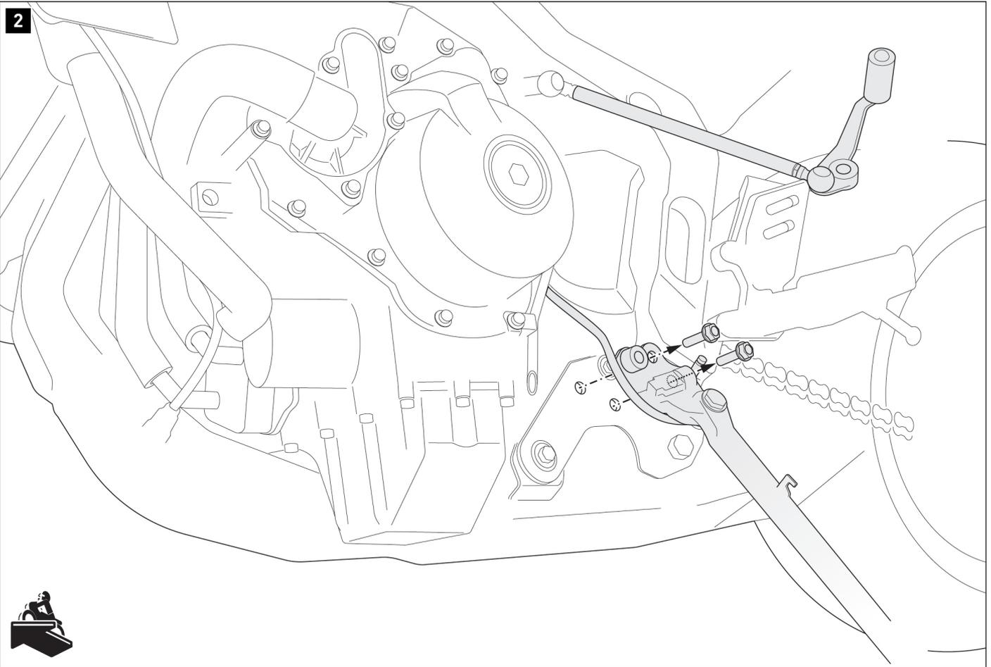
Entfernen Sie die gezeigte Schraube und lösen Sie den Seitenständer vom Anbaublech.
