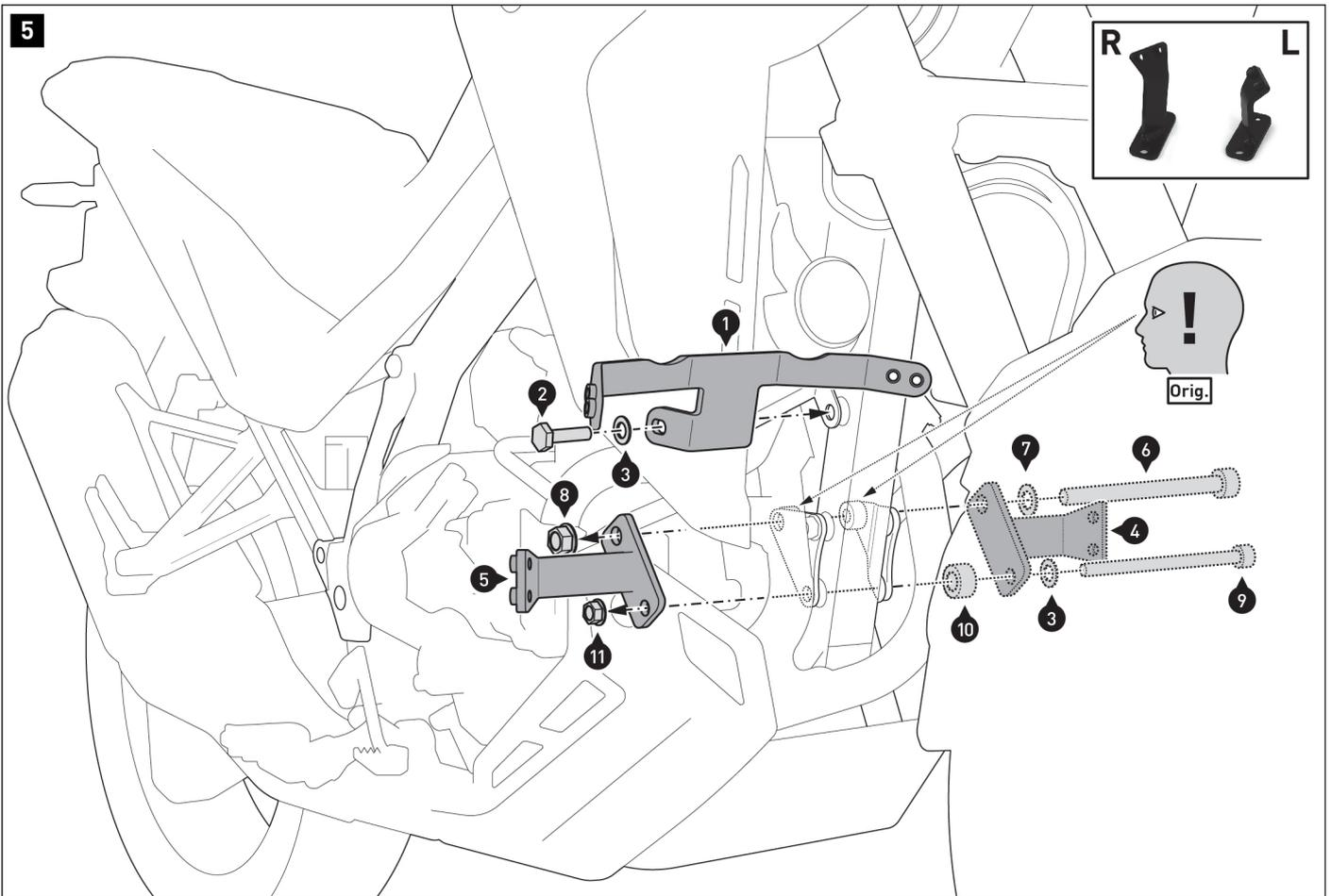
Montieren Sie den Querverbinder (1) und die Anbaustreben (4/5) am Fahrzeugrahmen.
