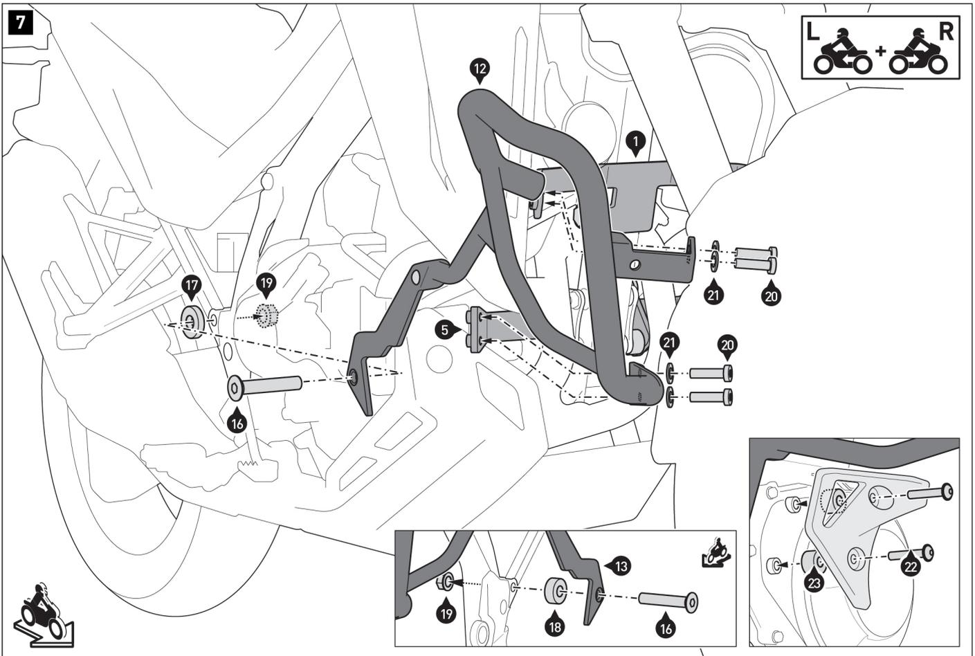
Verschrauben Sie die Sturzbügel (12/13) am Fahrzeug, dem Querverbinder (1) und den Anbaustreben (4/5).
